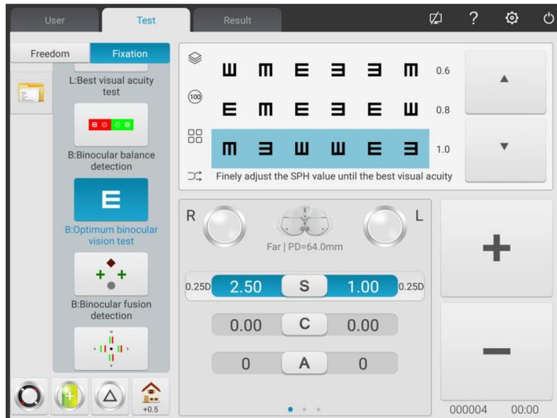
Reduza as pot ências esf éricas de dois olhos em -1.00D sincronicamente, remova o prisma na janela de teste binocular, chame a marca de mira 1.0; Aumente os poderes esf éricos de dois olhos em -0.25D sincronicamente at é que a marca de mira 1.0 seja vista claramente por dois olhos.
