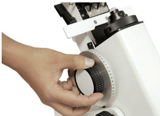
图 7.12 屈光度测量手轮
